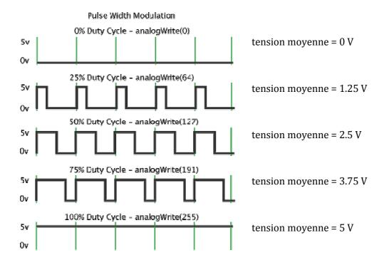
Pour certaines applications, une sortie PMW convient tout à fait. Par exemple, pour alimenter un moteur, ou pour faire varier la puissance d'une LED. Le circuit ci-après permet de faire varier l'intensité de la LED en fonction de la valeur demandée au port D3 défini par le programme comme une sortie analogique.
