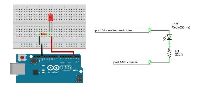
Le programme téléversé sur le microcontrôleur définit le port D2 comme une sortie. Quand le programme bascule la valeur de ce port à LOW, la LED est éteinte. Quand le programme bascule la valeur de D2 à HIGH, la LED s'allume. La résistance R1 sert à limiter le courant, ce qui protège à la fois le microcontrôleur et la LED (qui a également un courant critique au-delà duquel elle fume). Si la LED est montée en sens inverse, elle ne s'allumera jamais (c'est une diode).
