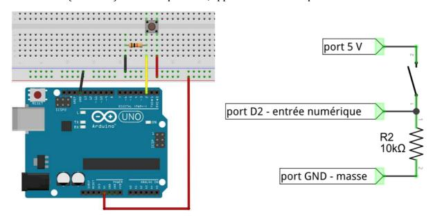
Maintenant, quand l'interrupteur est ouvert, D2 et la masse sont reliés directement sans courant entre eux, et la carte mesure bien 0 V (D2 est au même potentiel que la masse GND). Quand l'interrupteur est fermé, le potentiel du port D2 monte à 5 V (HIGH), et un courant de 0.5 mA circule entre le port 5 V et le port GND, ce qui n'est pas un problème.
