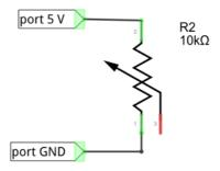
5) Utiliser un potentiomètre pour allumer une LED progressivement.
