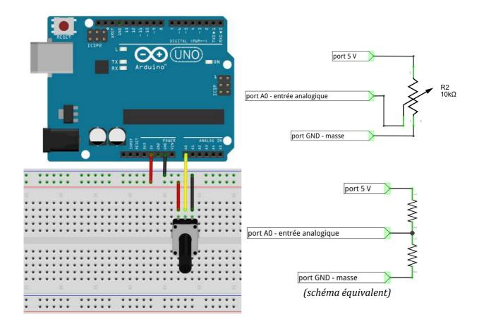
Le montage ci-dessus permet de mesurer une tension modifiée par un potentiomètre. Ce montage est équivalent à un pont diviseur de tension (voir le schéma équivalent). À la place du port 5 V de la carte arduino, on peut aussi utiliser une source externe pour alimenter le
